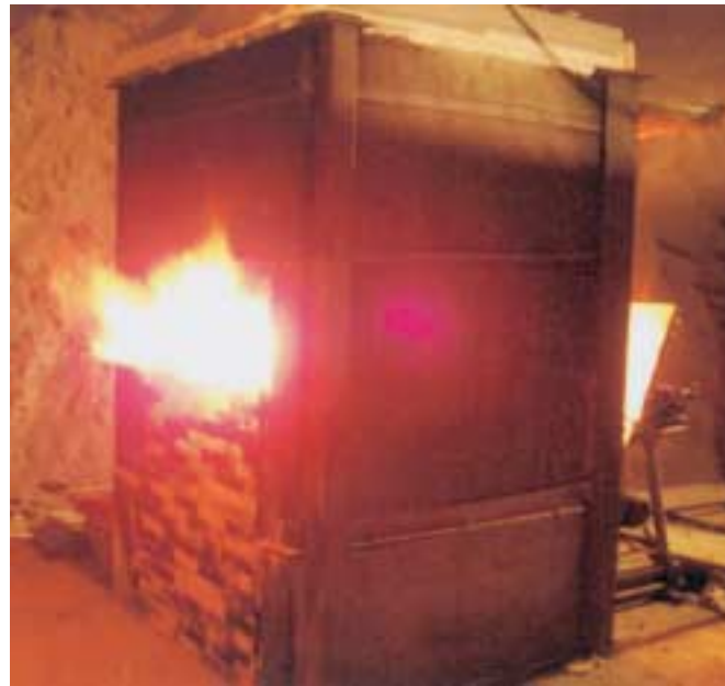
1 Probekörper aus B 55 mit 160 cm x 160 cm großem Prüffeld, das in 4 quadratischen Feldern mit unterschiedlichen Brandschutzmaterialien geprüft wurde
