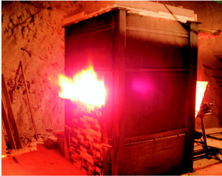
In den Brandversuchen mit Probekörpern aus Stahlbeton wurde ein Tunnelbrand simuliert
